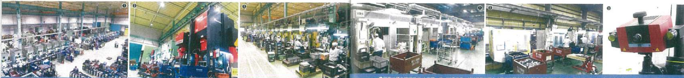
①プレス工程を集約した御嵩工場。25トンから500トンまで計51台のプレスが並ぶ。②SDE-3030（手前）をはじめとする200～300トンの単発プレスライン（御嵩工場）。③45～60トンの単発プレスライン（御嵩工場）
