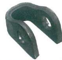
フォークリフトに使用するクレビス(駆動機構のブラケット)。高強度鋼板(SPH-440-OD)・板厚10mm。穴あけ後のU字空けて両側を出している
